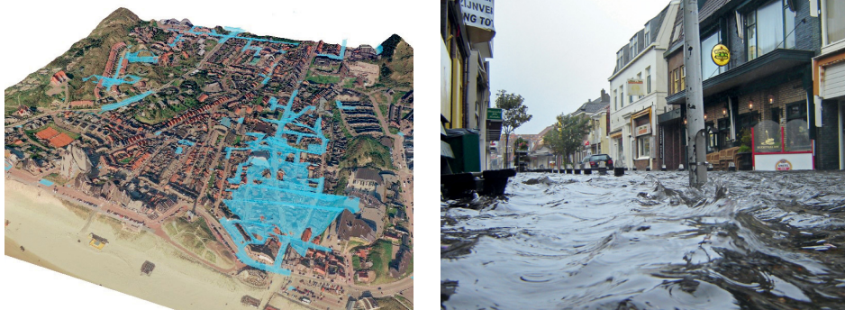
Figuur 4.1 Links: 3D-hoogtekaart impressie situatie 2006 bij circa 60 mm in 1 uur. Rechts: de laaggelegen Voorstraat met overlast in augustus 2006 (foto Roland Stam).
